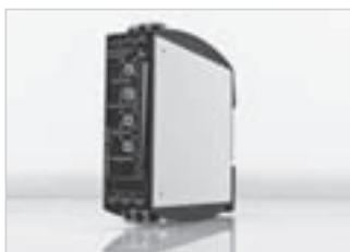
En el lado de la entrada pueden medirse corrientes alternas de hasta 15 A con conmutación en 3 áreas. El área de conversión se puede adaptar de forma óptima a la salida de 4-20mA mediante una función cero/span. La entrada, la salida y la alimentación están separadas en 3 vías. El convertidor de medida se integra óptimamente en aplicaciones de automatización de procesos gracias a su versatilidad.
