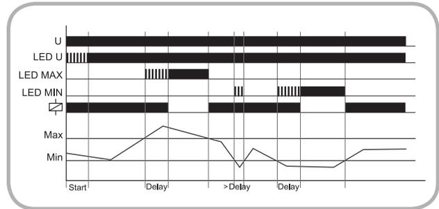
Si se selecciona la función memoria de defecto (LATCH), el relé de salida permanecerá desconectado después de un disparo por máxima o por mínima intensidad, incluso si la intensidad cae por debajo del valor (MIN) o sube por encima del valor (MAX) ajustados, respectivamente.
