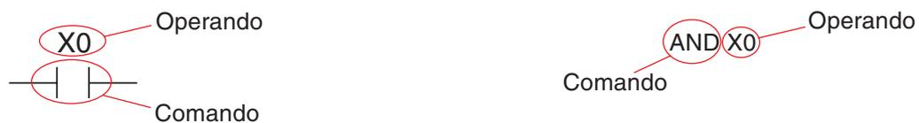
El comando describe lo que se debe hacer, o sea, la función que debe ejecutar el control. El operando indica con qué se debe ejecutar la acción. Su denominación se compone del identificador de operando y la dirección de operandos.
